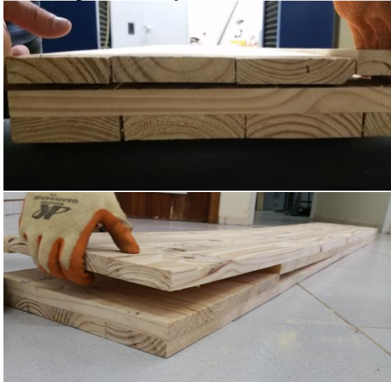
Figura 10 – Rompimento na linha de cola
